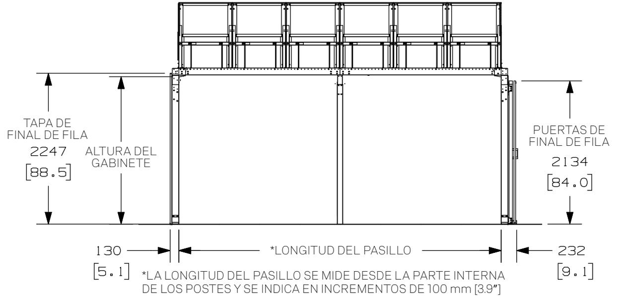
COMPATIBILIDAD DE ALTURA DE LA SALA PARA LAS SECCIONES DE PAREDES VERTICALES
