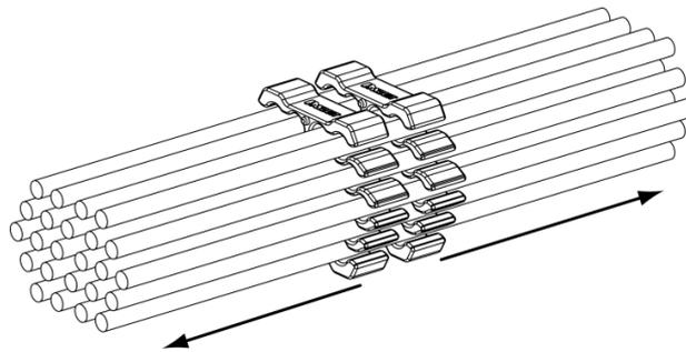
**PASO 4:** Después de separar los insertos, instale la cubierta con bisagras alrededor de cada inserto y asegúrela con el sujetador de gancho y bucle incluido para asegurar el conjunto. Cada una de las herramientas ahora se puede mover en cualquier dirección para organizar los cables. Aplique cinchos para cables en los intervalos deseados a medida que avanza a lo largo del mazo de cables.
