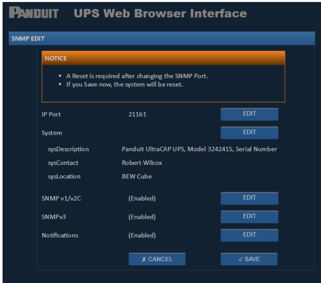
Figure 21 : page Web de la configuration SNMP (une fois le port IP modifié)
